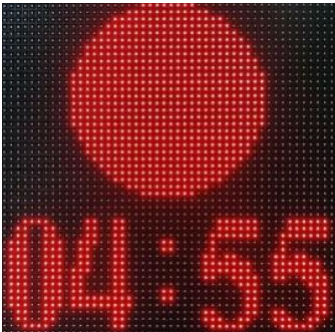
Вариант апертюры №1 при включении таймера обратного отсчёта при замкнутых контактах.
